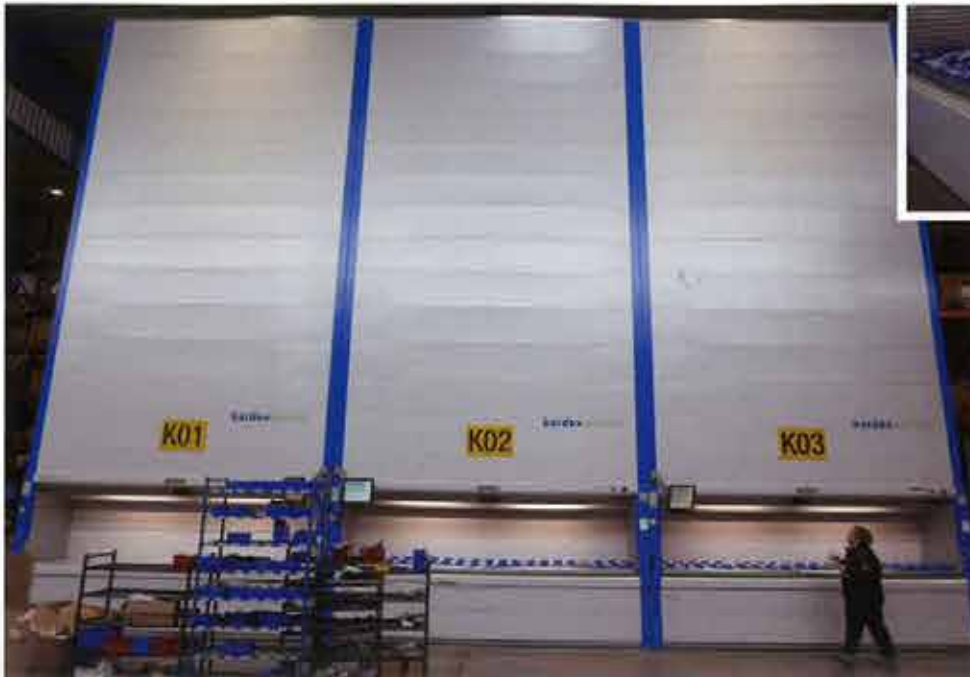
Trois Kardex de 9 m de haut permettent de stocker jusqu'à 7 500 références de produits de quincaillerie.
