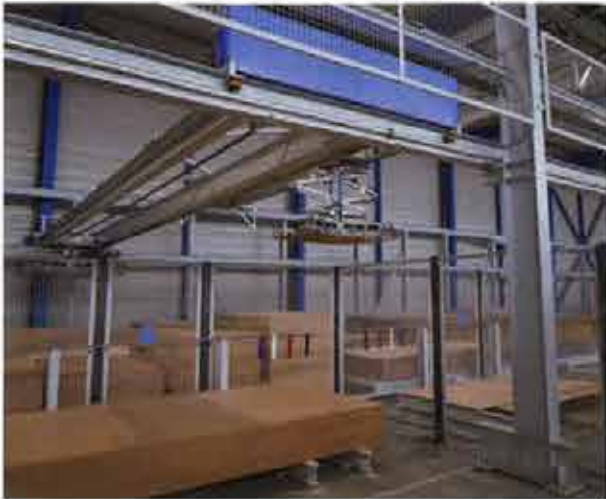
Le transstockeur de panneaux installé sur 60 x 16 m chez Bailly Quaireau peut accueillir jusqu'à 11 000 pièces et sera bientôt paramétré pour préparer cinq commandes de rang. Il lui faut environ 1 minute 30 pour sortir un panneau.
