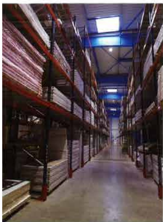
La plus grande partie du bâtiment dédié au stockage des produits manufacturés est occupé par des racks culminant à 9 m de hauteur, dont certains sont conçus pour accueillir des éléments de grandes longueurs.
